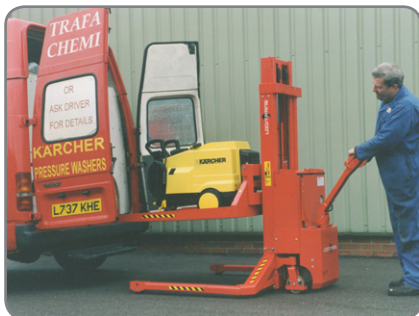
Het platform hier in gebruik voor het verplaatsen van een hogedrukreiniger.
