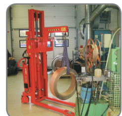
Metalen rollen worden gehoffen in een ponsmachine.
